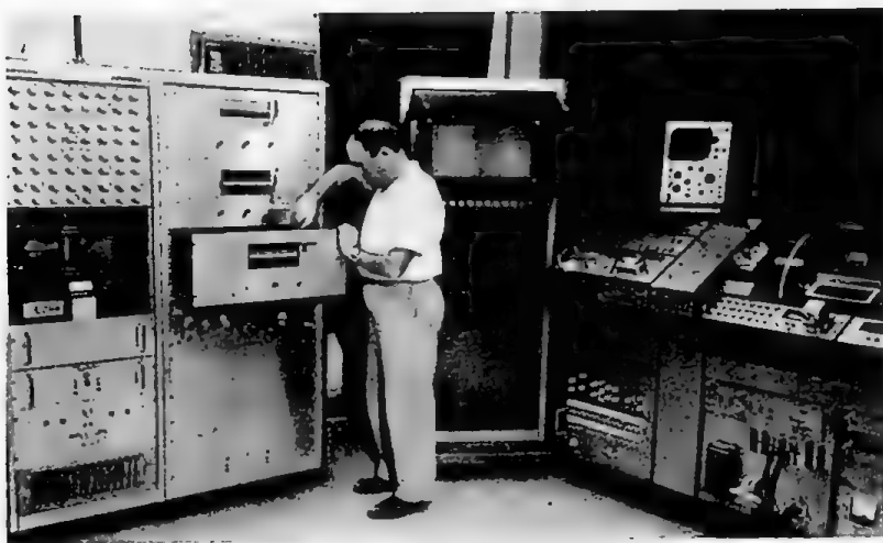
ציור 10-8. מראה כמעט כללי של המערכת האנלוגית S.I.E. הנמצאת במכון למחקרי נפט וגיאופיזיקה. סרט מגנטי המופעל בשדה. בשעת מחקרי השרה קולט את תוצאות המחקרים ; הסרט מוחקן בתוף הנמצא מימין למעלה לשם ניתוח, והתוצאה מתקבלת בפלט (מימין) בצורת מתחה גרפי או על מסך הקרנה (באמצע).
